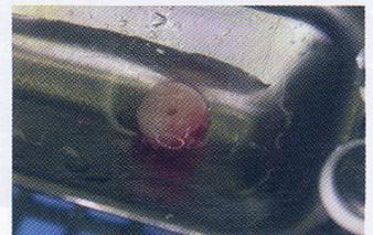
Bild 7: Knochenzylinder mit Loch für Schraube.
